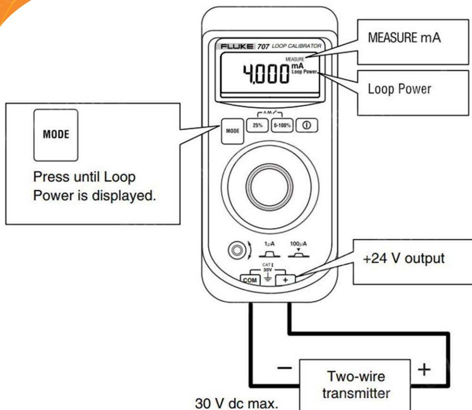
برای اندازه گیری جریان DC همراه با توان حلقه
