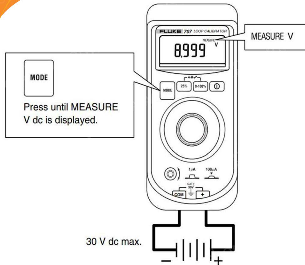
اندازه گیری ولتاژ
