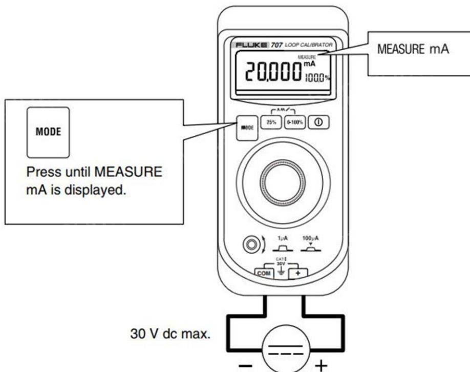
برای اندازه گیری جریان منبع دی سی بر حسب میلی آمپر با فشردن کلید مد دستگاه را در حالت مورد نظر قرار داده و منبع را به کمک رابطهای استاندارد مطابق با شکل به دستگاه متصل کنید
